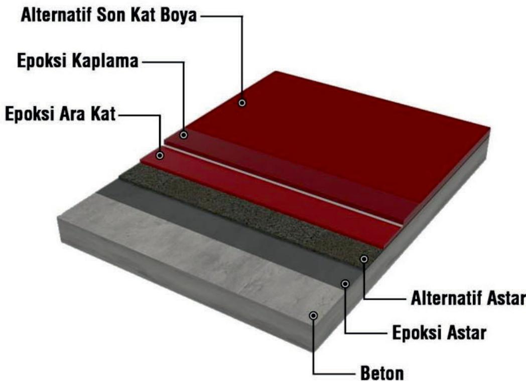
Düzenli yüzey bitişli, kendiliğinden yayılabilen, yüksek mekanik ve kimyasal dayanımı olan, hijyenik, solventsiz epoksi kaplama sistemidir.
