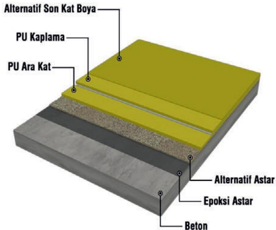
Düzgün yüzey bitişli,kendiliğinden yayılabilen, mekanik ve kimyasal dayanımı yüksek olan, hijyenik, solventsiz poliüretan zemin kaplama sistemidir.
