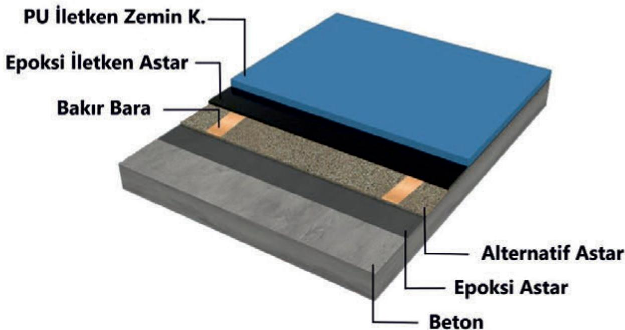
Düzgün yüzey bitişli, kendiliğinden yayılabilen, mekanik ve kimyasal dayanımı yüksek olan solventsiz, hijyenik, antistatik poliüretan zemin kaplama sistemidir.
