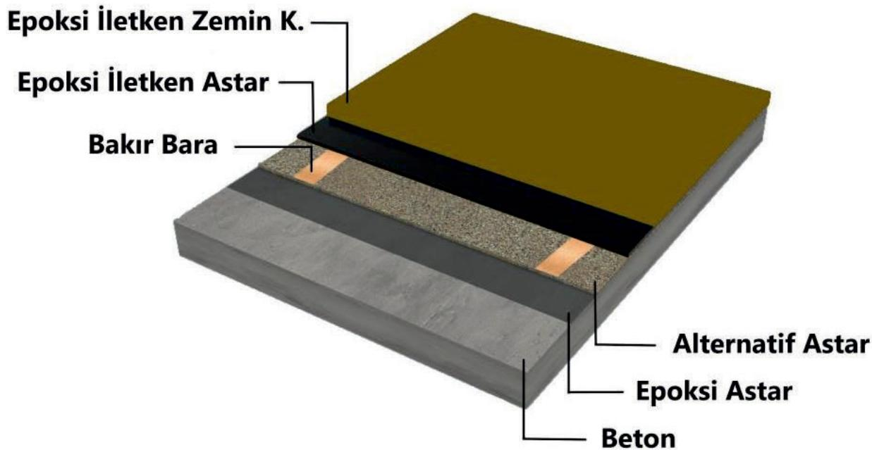
Düzgün yüzey görünümlü, kendiliğinden yayılabilen, solventsiz, antistatik epoksi zemin kaplama sistemidir.
