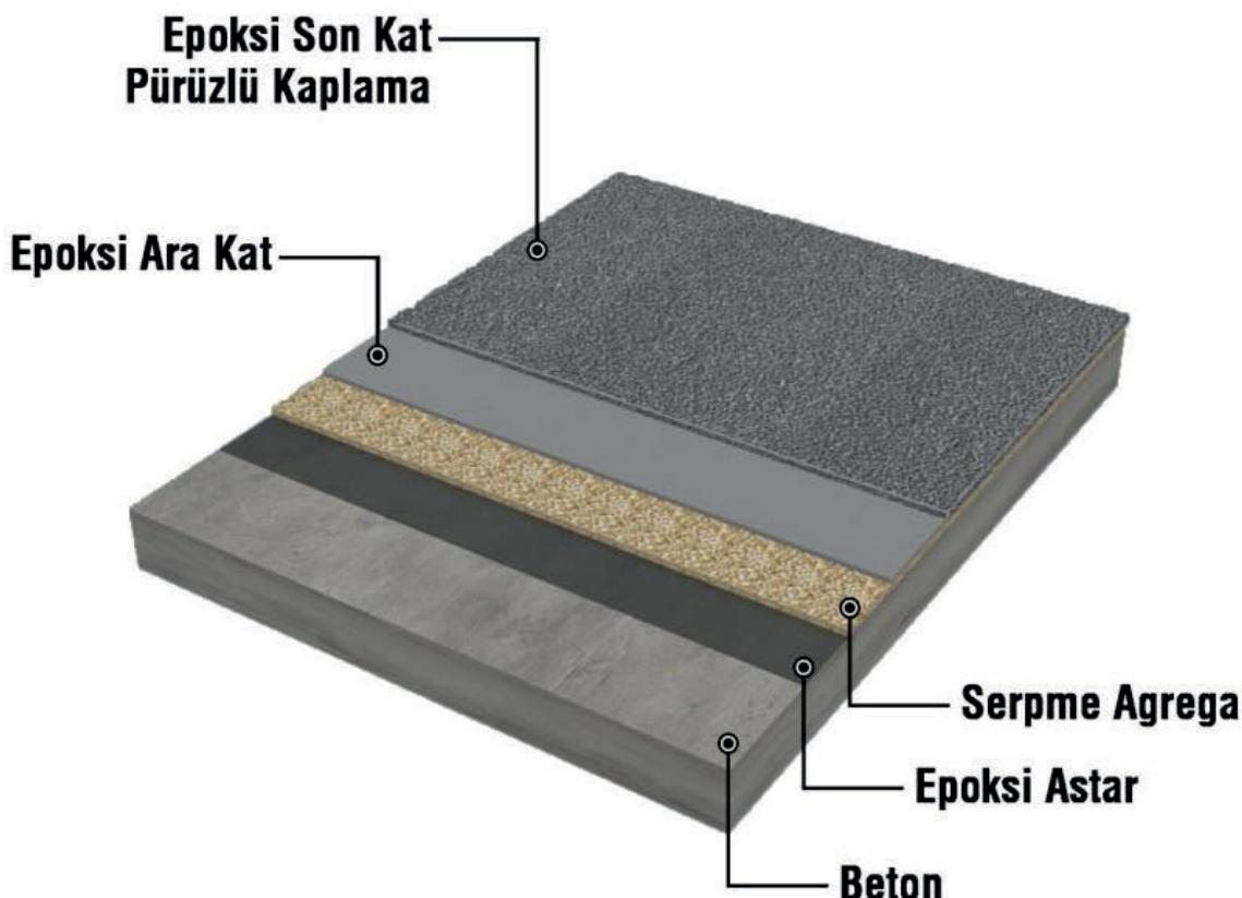
Pürüzlü yüzey görünümlü yüksek mekanik ve kimyasal dayanımı olan, solventsiz, kaymaz, hijyenik epoksi zemin kaplama sistemidir.
