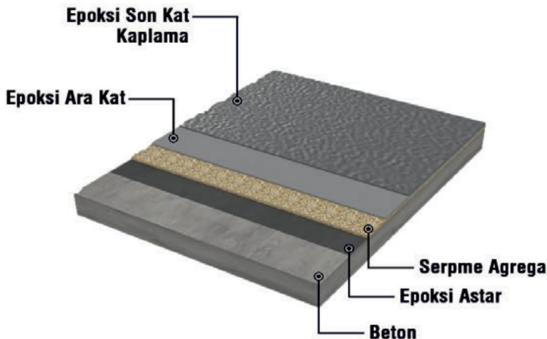
Tekstürlü desen görünümlü, yüksek mekanik ve kimyasal dayanımı olan, solventsiz epoksi zemin kaplama sistemidir.
